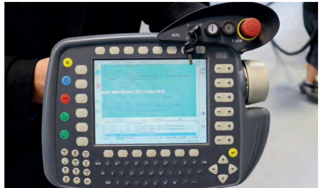
Pedant til brug ved arbejde inde i robotcellen
