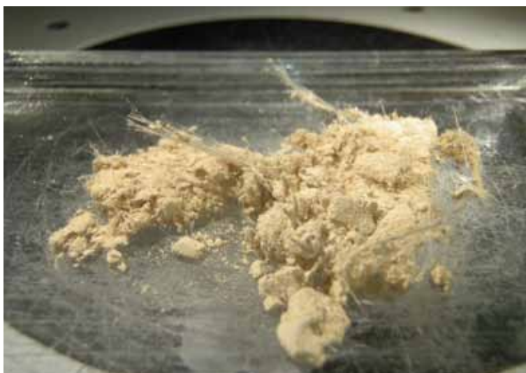
Teknisk isolering med brun asbest. Denne type isolering bruges typisk i rørbøjninger.
