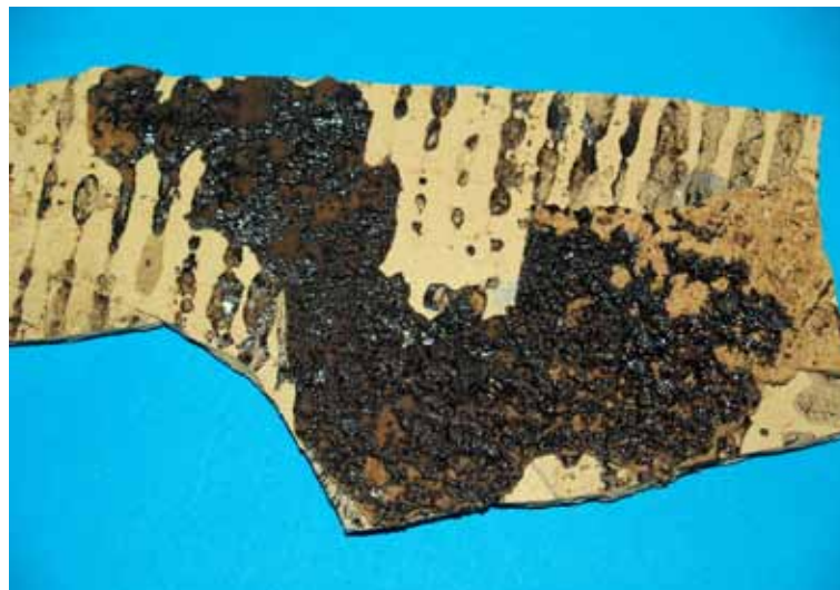
Bitumenklæ- ber. Asbest har været meget brugt som til- slagsmateriale i bitumen til at lime gulvmate- rialer fast ned.
