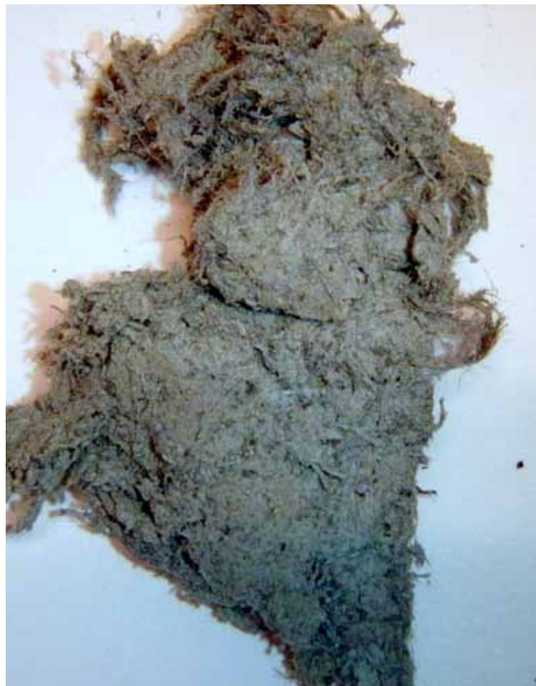
Klump med blå asbest. Blå asbest har typisk været anvendt som sprøjteasbest i fx maskinrum på ældre flådefartøjer.
