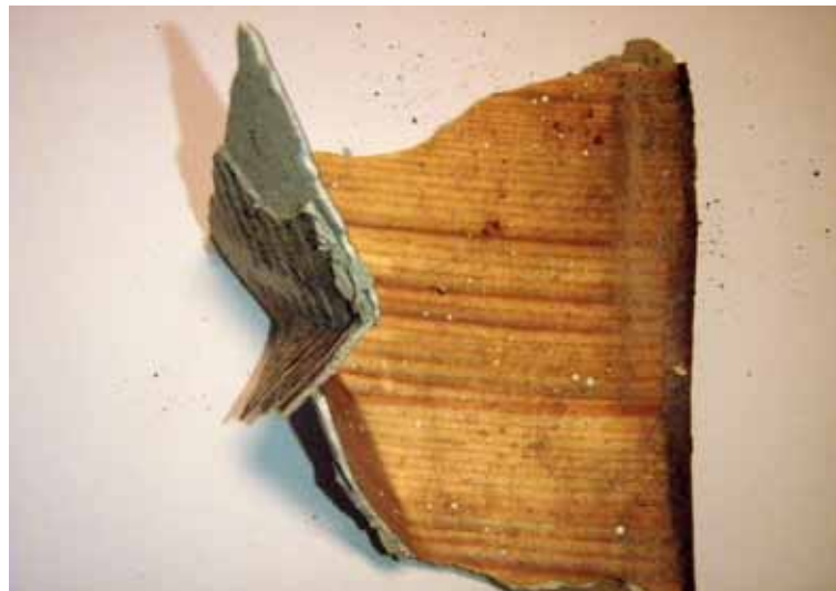
Væg/gulv- beklædning bestående af imiteret træ (vinyl), hvorun- der der er et lag asbestpap.
