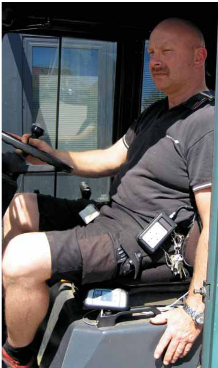
Støjbelastningen på førerpladsen måles ved hjælp af et støjdosisimeter med mikrofon placeret på skulderen.
