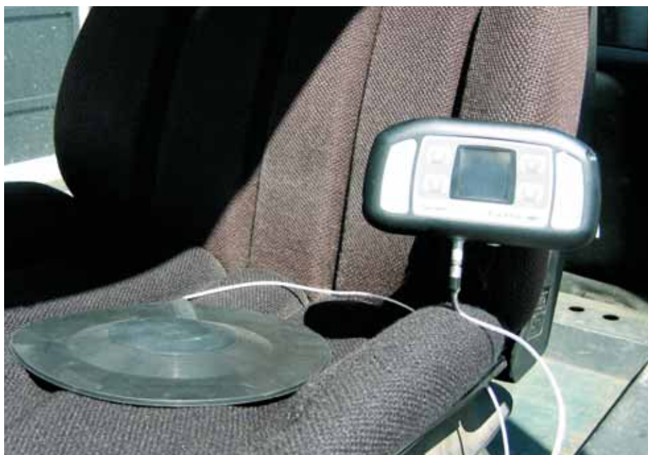
Vibrationsbelastningen på førerpladsen måles med en special transducer, som placeres på sædet, og en tilhørende vibrationsmåler.
