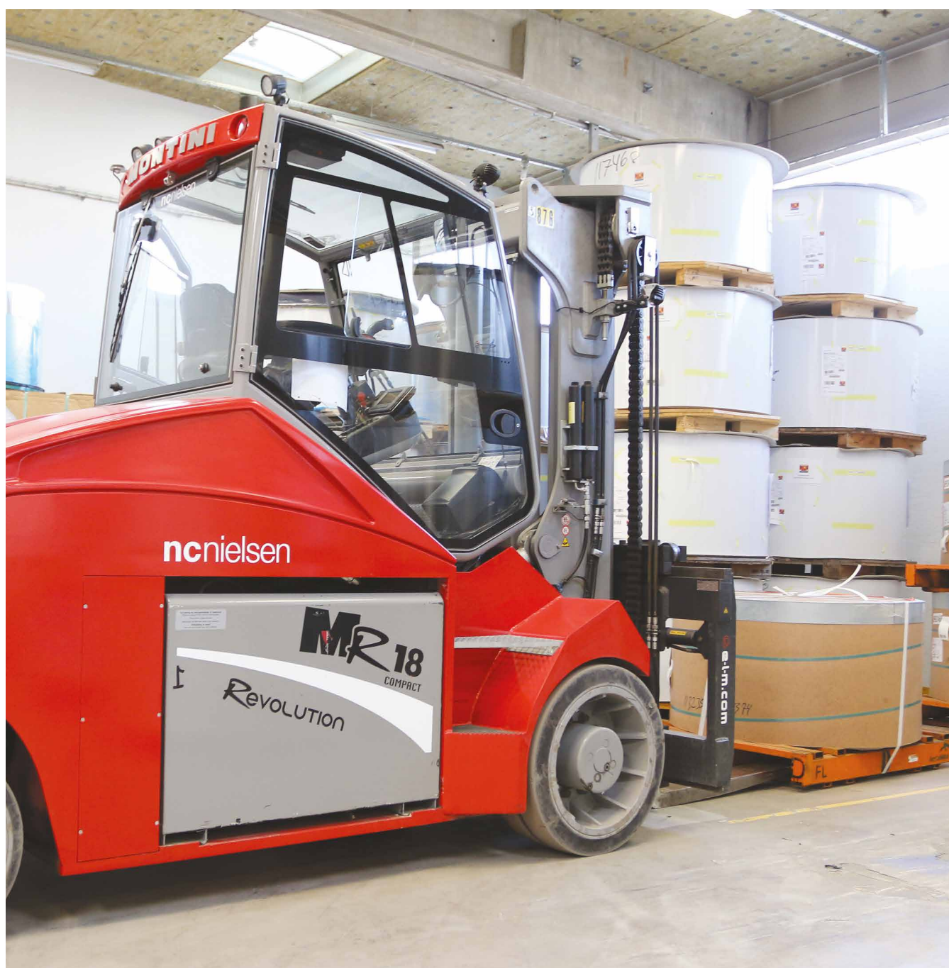
Stor og kraftig batteritrukk, der vil kunne erstatte en dieseldrevet gaffeltruck
