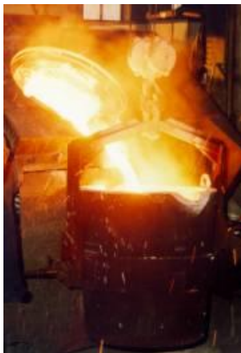
Figur 5: Til venstre ses omhældning af smelte fra ovn til støbeske. Til højre ses udstøbning hvor smelten hældes i en støbeform.
