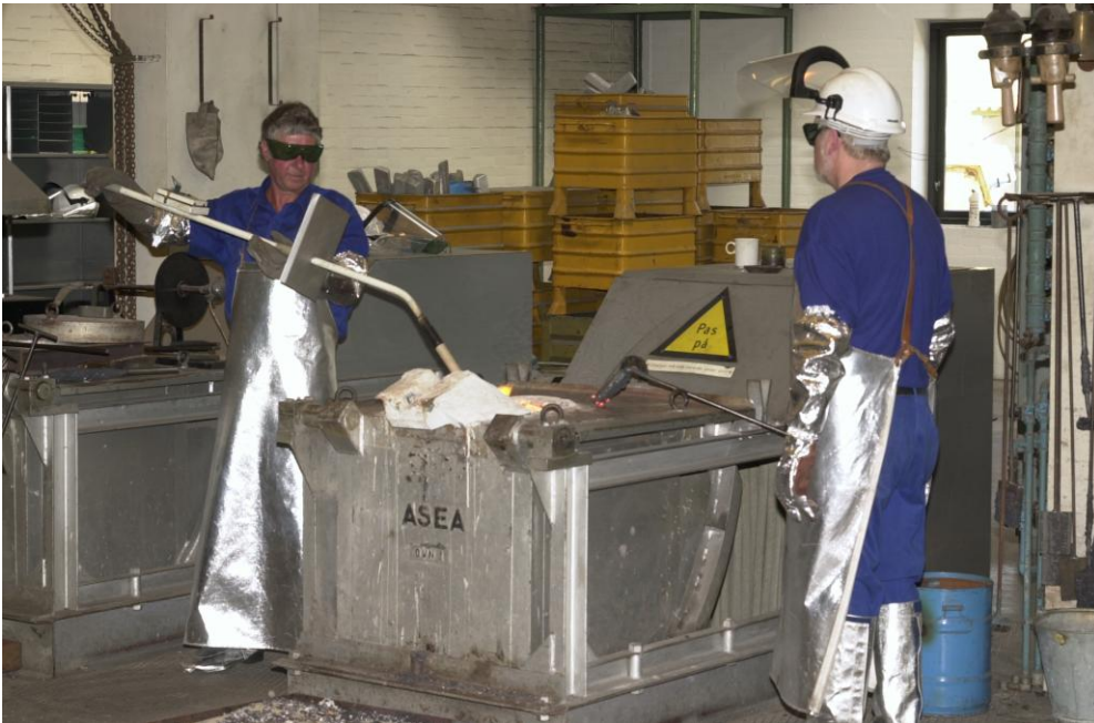
Figur 3: Smeltning i en lille induktionsovn. Manden til venstre måler temperaturen i smelten, og ham til højre fjerner slagge.
