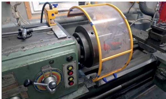
Skærm med sikkerhedsafbryder monteret på drejebænk
