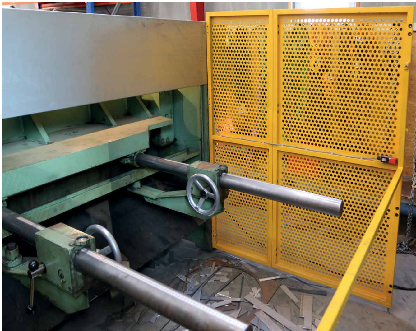
Sikringsgitter med overvåget bom bag pladesaksen.
