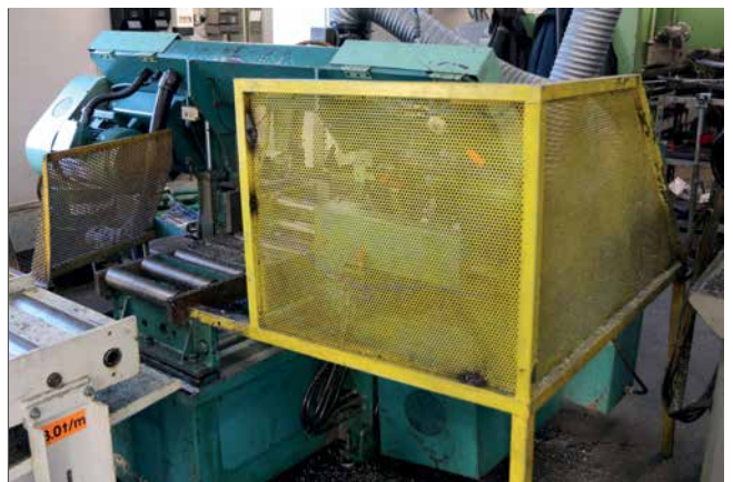
Afskærmning ved savens bagside hindrer indrækning til fremtrækket.
