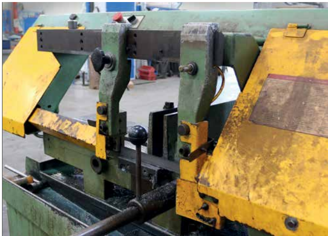
Justerbar klingeafskærmning på båndsav til metal.
