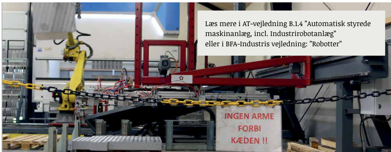
Let flytbar advarselskæde foran lysgitteret.
