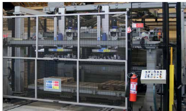
Betjeningspult udenfor sikkerhedsgitteret.
