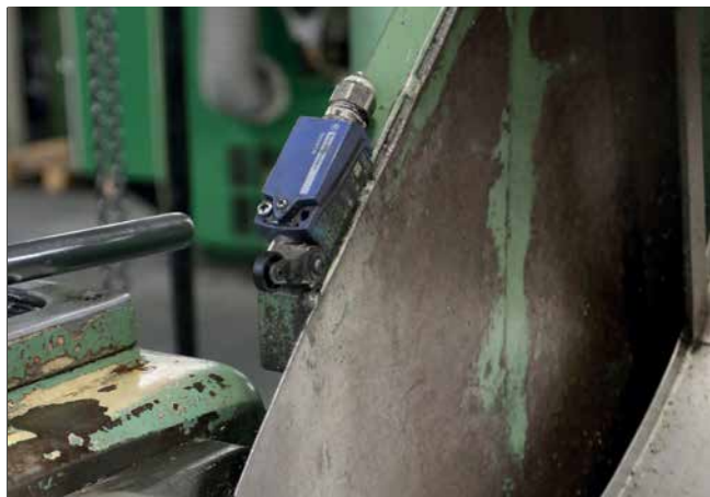
Sikkerhedsafbryder på afskærmning, der kan åbnes
