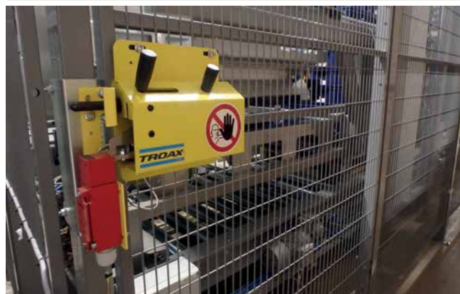
Dørlås, som først kan åbnes, når palleteringsanlægget er standset.
