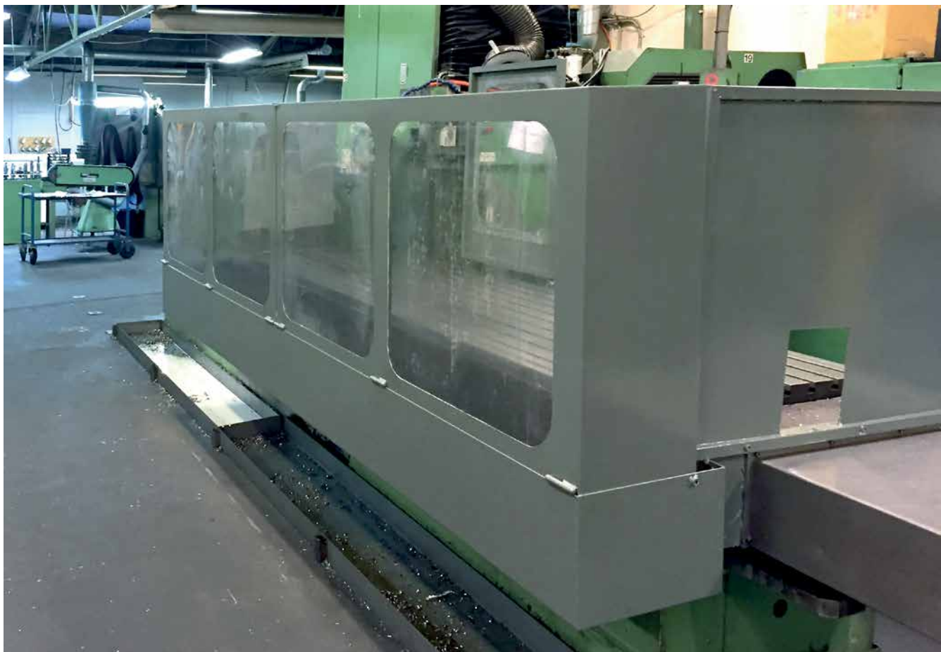
Stor bed-fræser med fuld afskærmning.
