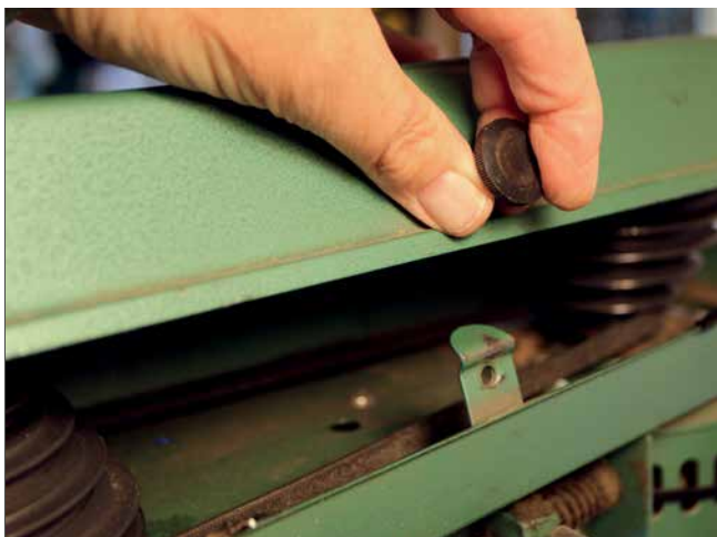
Et dæksel med fingergreb kan let sikres med en skrue.
