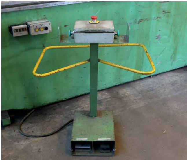
To-håndsbetjening med nødstop og fodpedaler til at styre op- eller nedbevægelsen.
