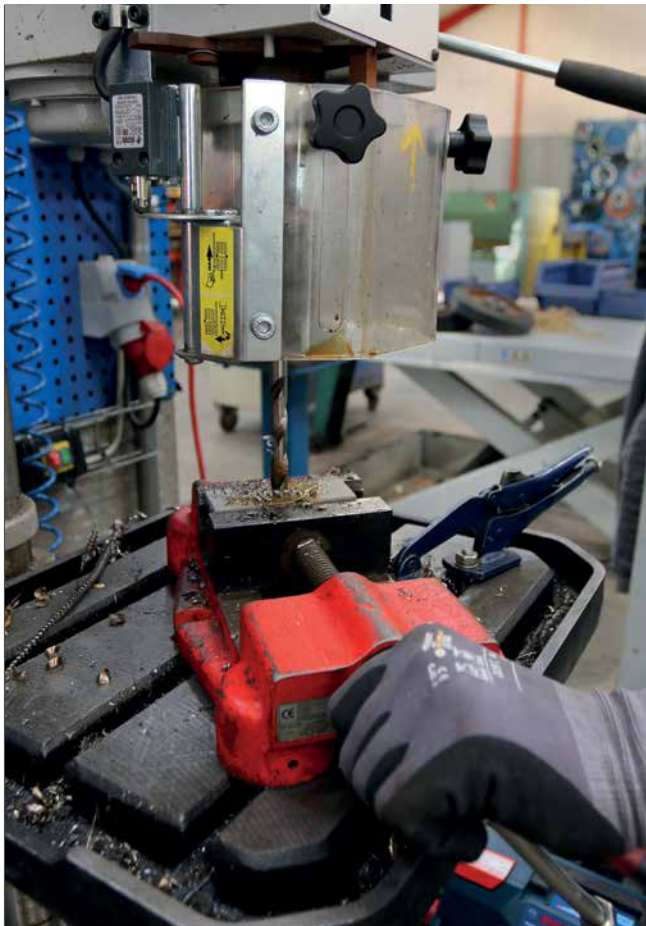
Vipbar afskærmning af borepatron.
