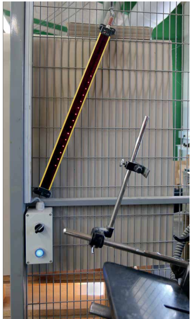
Lysgitter med reset-knap:
