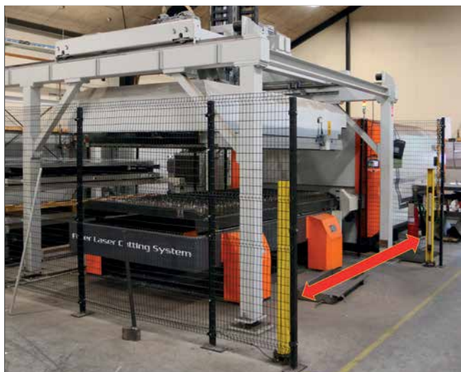
Metalgitter kombineret med lysgitter ved tilgangsvej.
