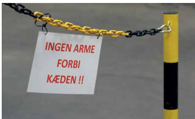
Let flytbar advarselskæde foran lysgitteret.
