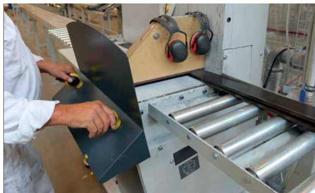
To-håndsbetjening ved automatisk afkorter.
