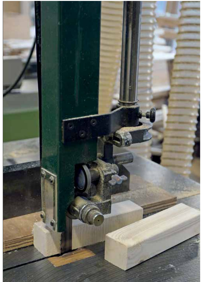
Justerbar klingeafskærmning på båndsav til træ.
