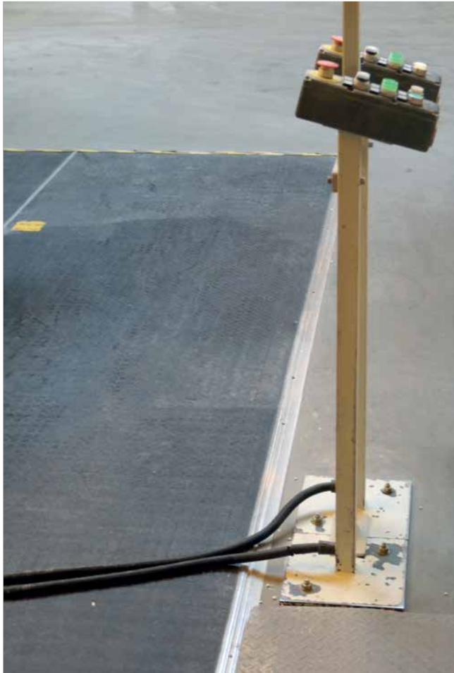
Trædemåtte mellem betjeningspult og en åben fræser.
