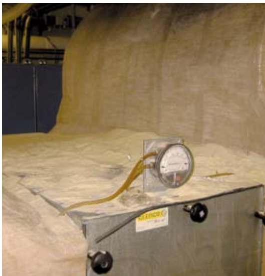
Pulveret på billedet er meget groft (store støvpartikler). Eksplosionsrisikoen er derfor minimal, men der skal gøres rent alligevel.
