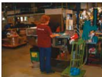
I vores kabel afdeling har vi fået 2 Hovman lifte for at undgå akave løftestillinger. Kablerne på billedet vejer fra 2 - 4 kg.
