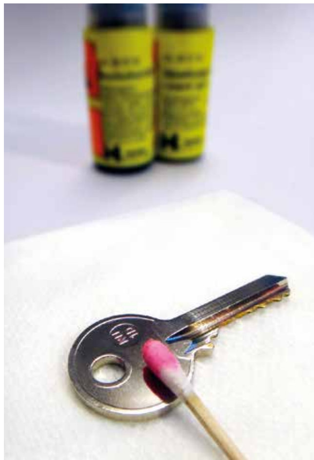
Figur 6: Nikkelfrigivelse fra nøgle vist ved nikkelspottest (lyserød farve).
