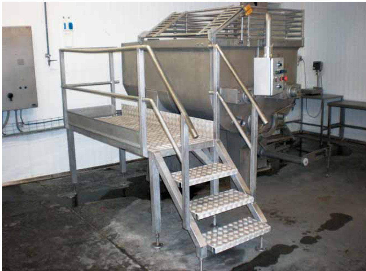
Platform med gelænder
