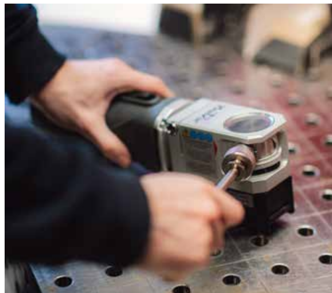
Mobil slibemaskine til wolframelektrode med støvfilter som opsamler støvet.
