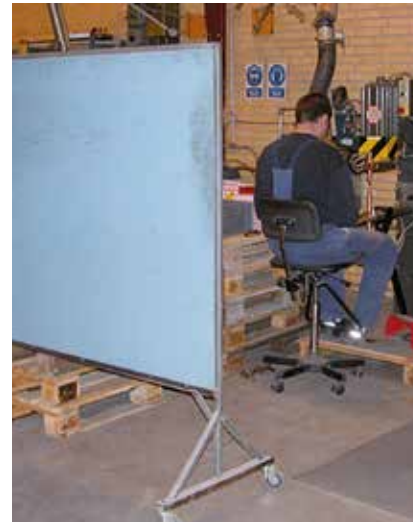
Svejsoplads bag flytbare skærme. Giver fleksibilitet og kan flyttes i forhold til opgaver og kan også begrænse udbredelsen af støj.
