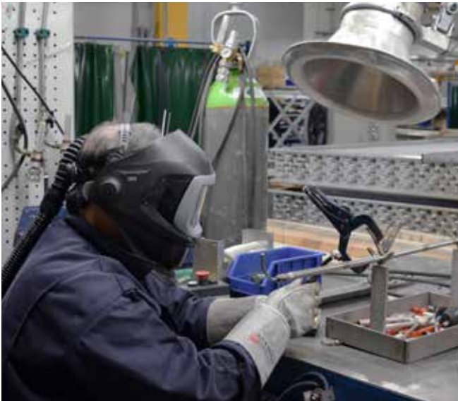
Korrekt placeret lavtryksudsugning.
