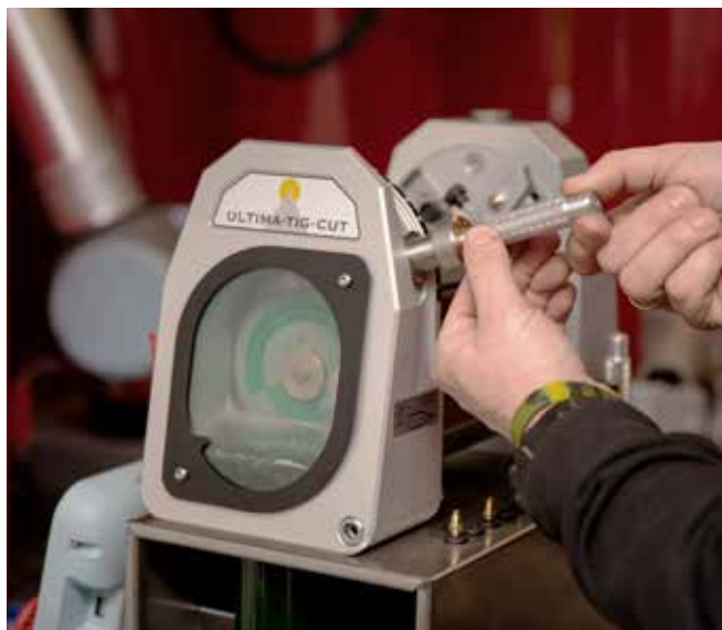
Slibemaskine til wolframelektrode på fast arbejdsplads med beholder, som opsamler slibestøvet.
