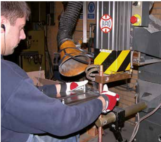
Korrekt placeret lavtryksudsugning.
