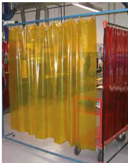
Svejseskabine, med gennemsigtige gardiner. Giver et mere transparent arbejdsmiljø, med mulighed for dagslystilgang og udsyn.
