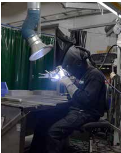
Svejseskabine med mørke gardiner. Mulig risiko for at svejseren føler sig isoleret og at en ulykke ikke opdages i tide.
