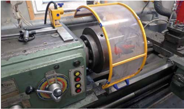
Skærm med sikkerhedsafbryder monteret på drejebænk
