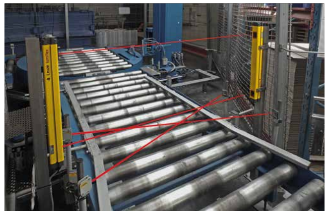
Lysgitter med forbikobler ved udkørsel fra pakkerobot.
