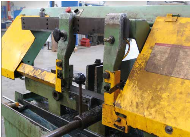
Justerbar klingeafskærmning på båndsav til metal.
