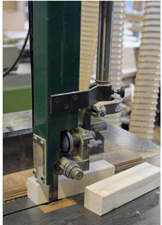
Justerbar klingeafskærmning på båndsav til træ.
