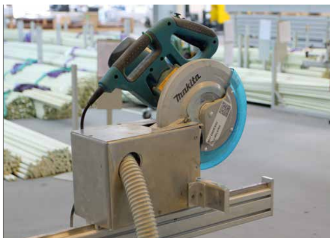
Moderne kapsav med ”dødemands-greb” og skærme, fastmonteret med spånudsugning.
