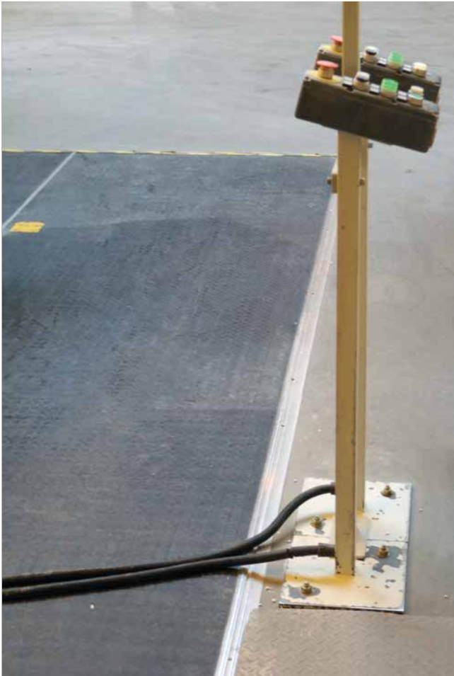
Trædemåtte mellem betjeningspult og en åben fræser.
