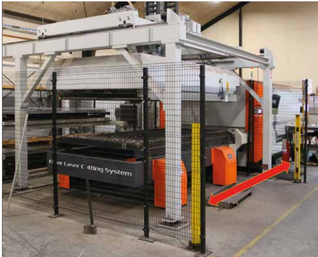
Metalgitter kombineret med lysgitter ved tilgangsvej.
