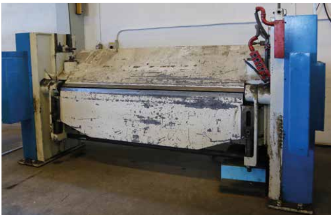
Svingbukkeren. De blå "kasser" afskærmer mod at blive ramt af bukkevange og plade i siderne.
