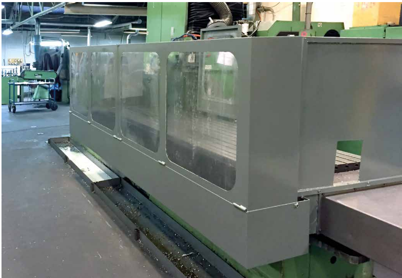
Stor bed-fræser med fuld afskærmning.
