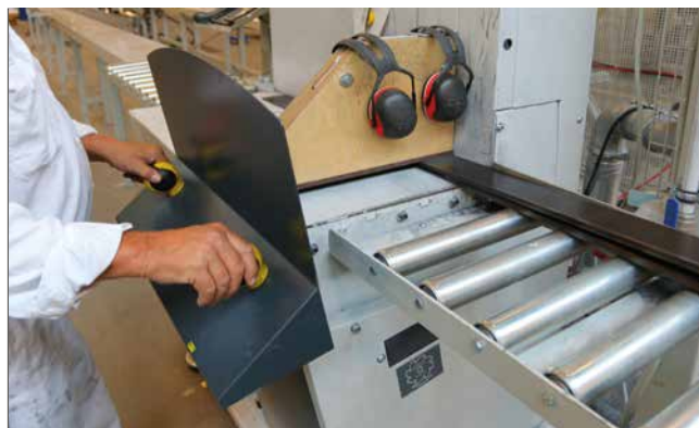
To-håndsbetjening ved automatisk afkorter.
