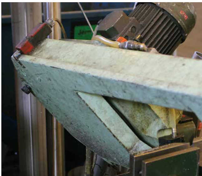
Eftermonteret lågkontakt på metalsaven.
