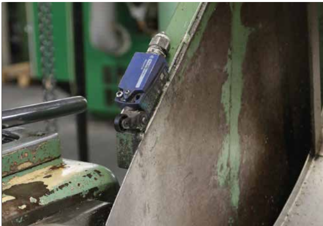
Sikkerhedsafbryder på afskærmning, der kan åbnes
