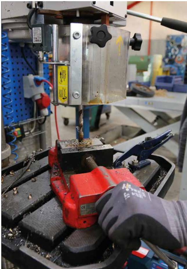
Vipbar afskærmning af borepatron.
