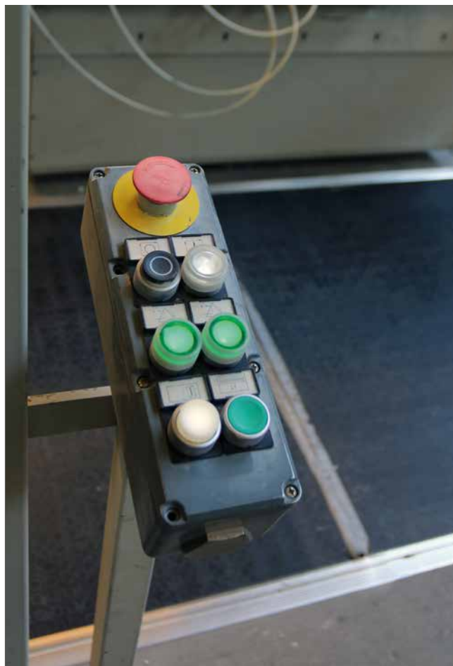
Trædemåtter mellem betjeningstryk og maskine, så man ikke kan gå til maskinen under drift.
