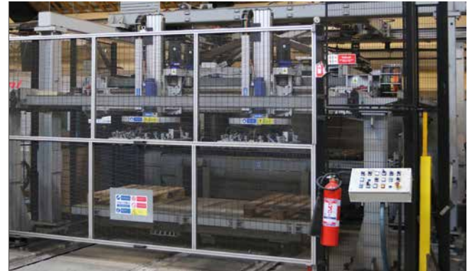
Betjeningspult udenfor sikkerhedsgitteret.
