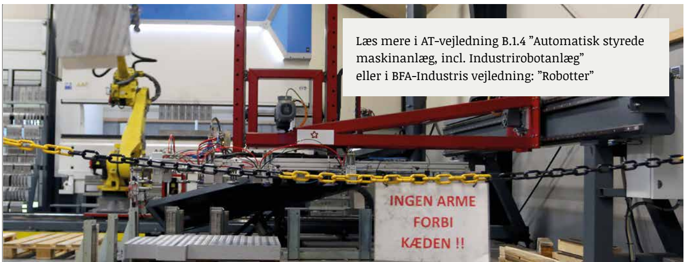
Let flytbar advarselskæde foran lysgitteret.
